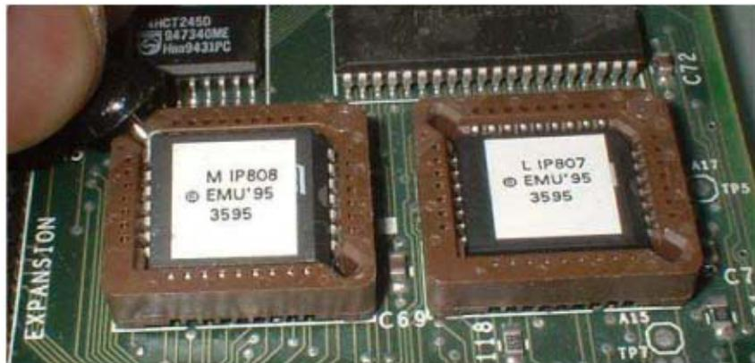
**Wichtiger Hinweis: Achtet bitte unbedingt darauf, dass Ihr mit dem Hebelwerkzeug (Pinwandnadel) nicht zu tief einstecht, nicht dass die Leiterbahn unter dem Sockel beschädigt oder sogar durchgetrennt wird!**
